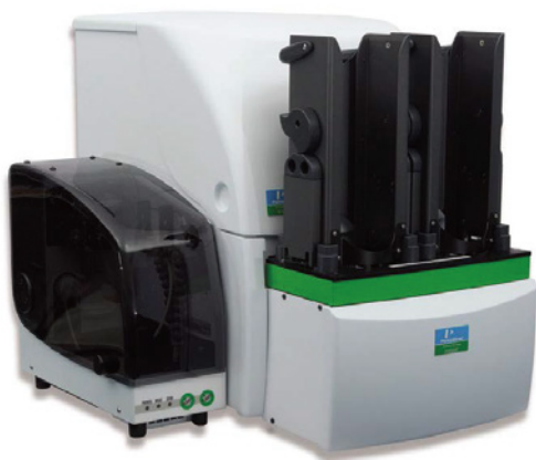
带自动加样器和载板架的 EnVision 微孔板检测仪
